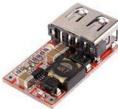
**Gambar 2.7 Module 6-24V 24V 12V To 5V [17]**
