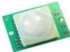
Gambar 2.11 Sensor PIR HC-SR501 [15].
