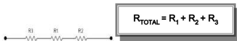
Gambar 2.11 Rumus Rangkaian Serial Resistor
