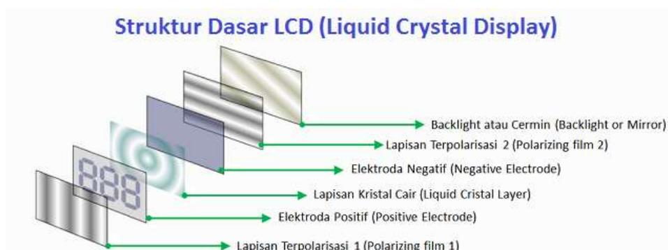
**Gambar 2.13 Struktur LCD[23]**
