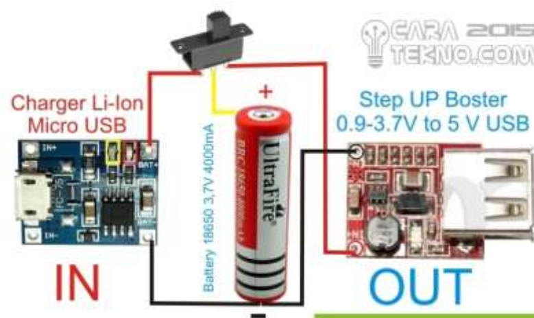
Gambar 2.9 Prinsip Kerja Module Charger
