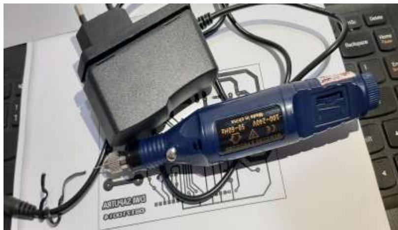
Gambar 2.20 Mesin Bor Pcb
