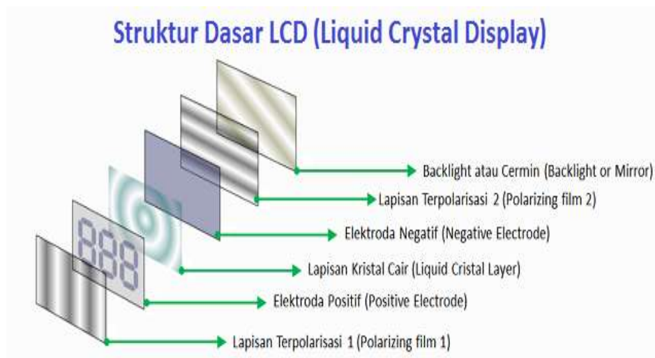
Gambar 2.12 Prinsip Kerja LCD [12].
