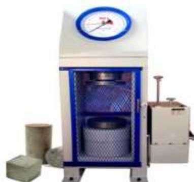
Gambar 2.5 Alat uji kuat tekan beton Sumber : Google
