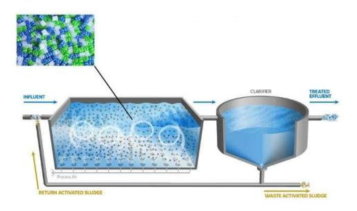
**Gambar 2. 1** Ilustrasi Penggunaan MBBR (*Moving Bed Biofilm Reaktor*) Sumber: grinvirobiotekno.com diakses pada tahun 2020
