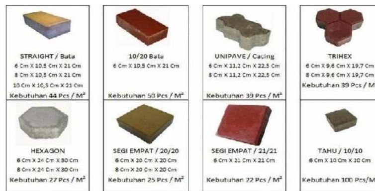
Gambar 2.1. Bentuk - Bentuk Paving Block
