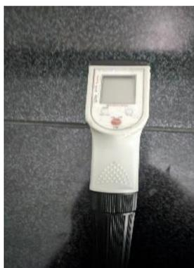
Gambar 3.4 Alat Ukur pH Meter
