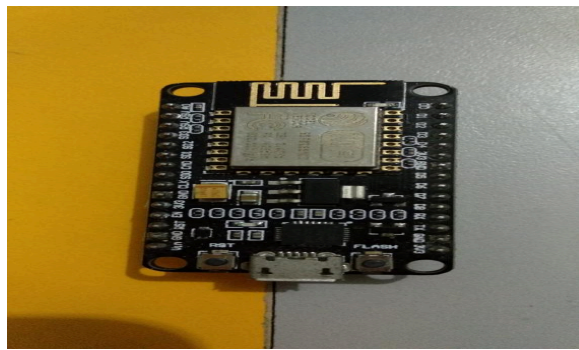
Gambar 2. 1 NodeMCU ESP8266 (Sumber : Dokumen pribadi )
