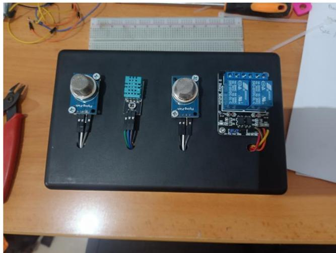
Gambar 3.7 Perakitan alat sistem pencegah kebakaran IoT
