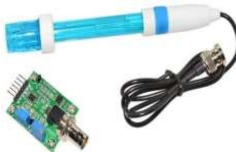
**Gambar 2.4 Sensor pH PH-4502C**
